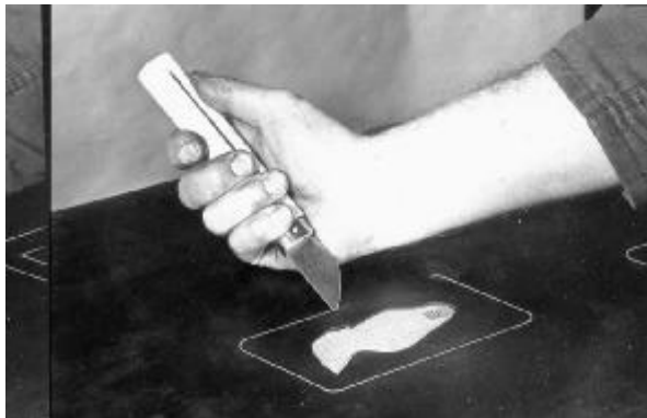
Повреждения обкладочного слоя покрывать твердым слоем НИЛОС типа ТН
